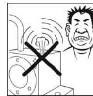
**GEFAHR:** Der Betrieb ohne Schalldämpfer sollte vermieden werden (ggf Ohrenschaden)! Austretende Öldämpfe nicht einatmen. Empfehlung: Abluft abführen. Siehe Sicherheitsdatenblatt. [www.findeva.com](http://www.findeva.com)
